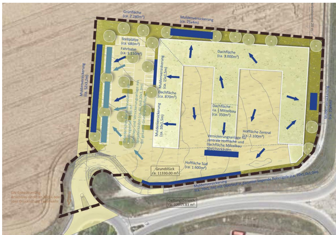
Abbildung 6: Umgang mit Niederschlagswasser (Quelle: LARS consult)
