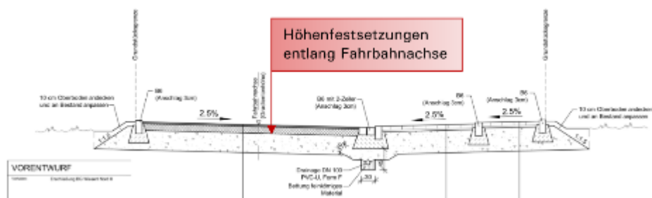
Abb.: Regelquerschnitt Haupteerschließung - Städtebaulicher Entwurf 03/2024
