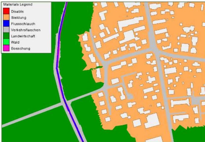
Abbildung 2: Auszug Materialzuweisung im 2D-HN-Modell (Grafik: 2D-HN-Modell Sweco)
