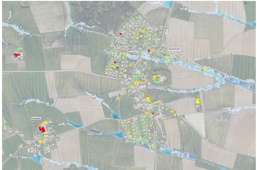
Fließwege bei Starkregen und Geländesenken sowie Betroffenheit von Gebäude, Ortsteil-ausschnitt Seyboldsdorf, Karte: Integrale Konzepte zum Hochwasserschutz und zum Sturzflut-Risikomanagement 2021
