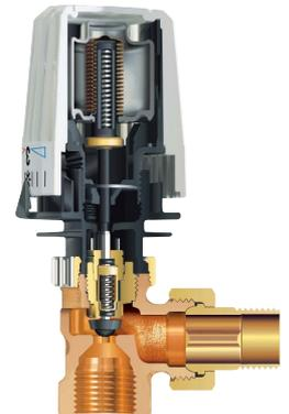
Bild 12: Längsschnitt durch ein Thermostatventil (Quelle: Fa. Heimeier)
