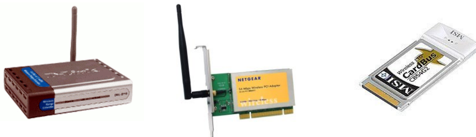
Bild 2.1 WLAN Access-Point (links), Einschubkarte für PC (Mitte), PCMCIA-Karte für Laptop (rechts)
