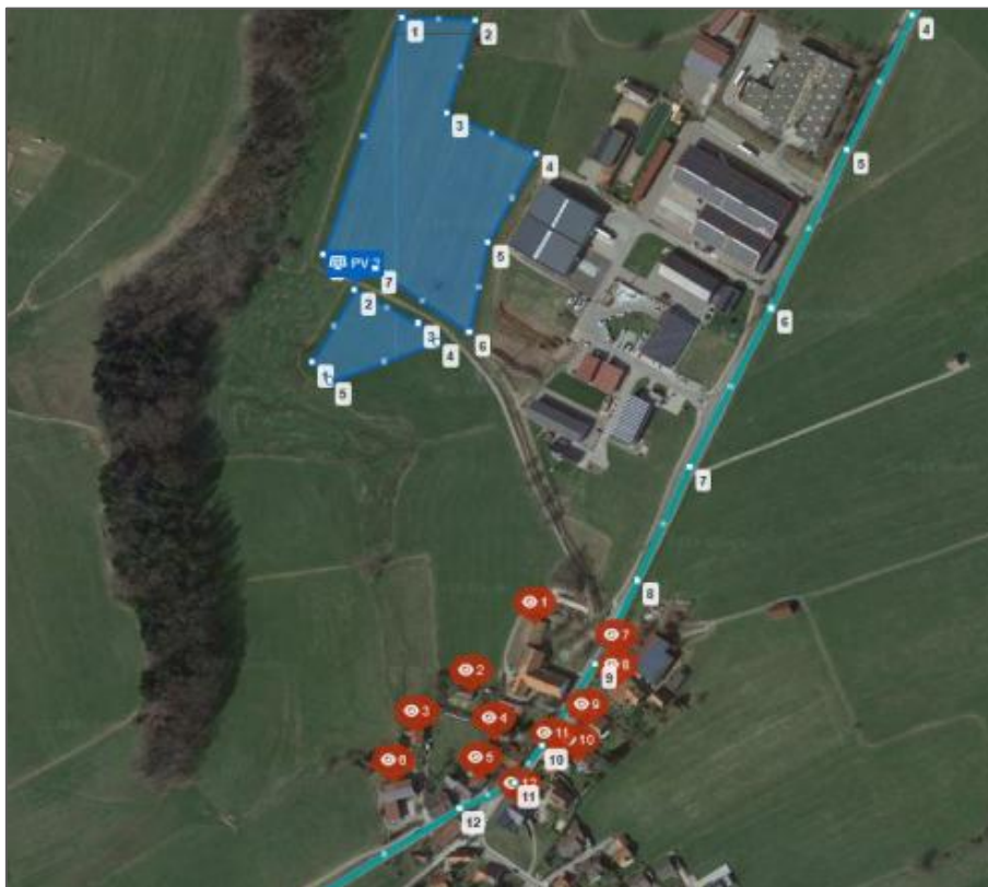
Abbildung 13: Immissionsorte in der Simulationssoftware (Quelle: Blendgutachten für den Solarpark Günzburg, DGS Landesverband Berlin Brandenburg e.V., 28.03.2025, S. 13), maßstabslos
