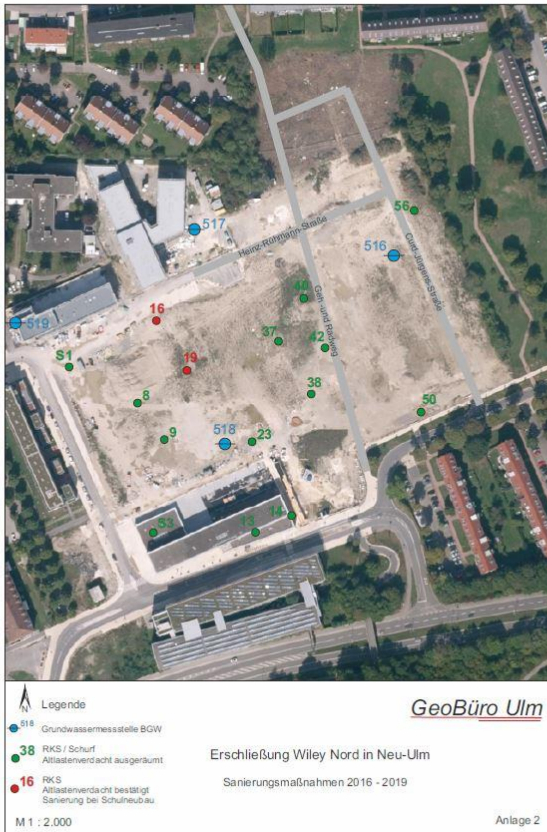
Abb. 3: Lageplan Sanierungsmaßnahmen 2016 – 2019, GeoBüro Ulm
