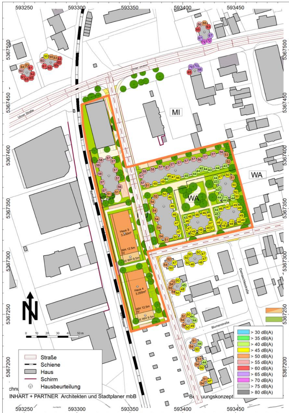
Abbildung 25: Höchster Beurteilungspegel L_p am Tag aufgrund von Verkehrslärm entlang der Fassaden von Wohngebäuden inner- und außerhalb des Plangebiets im Prognose Planfall ohne Haus 3/4
