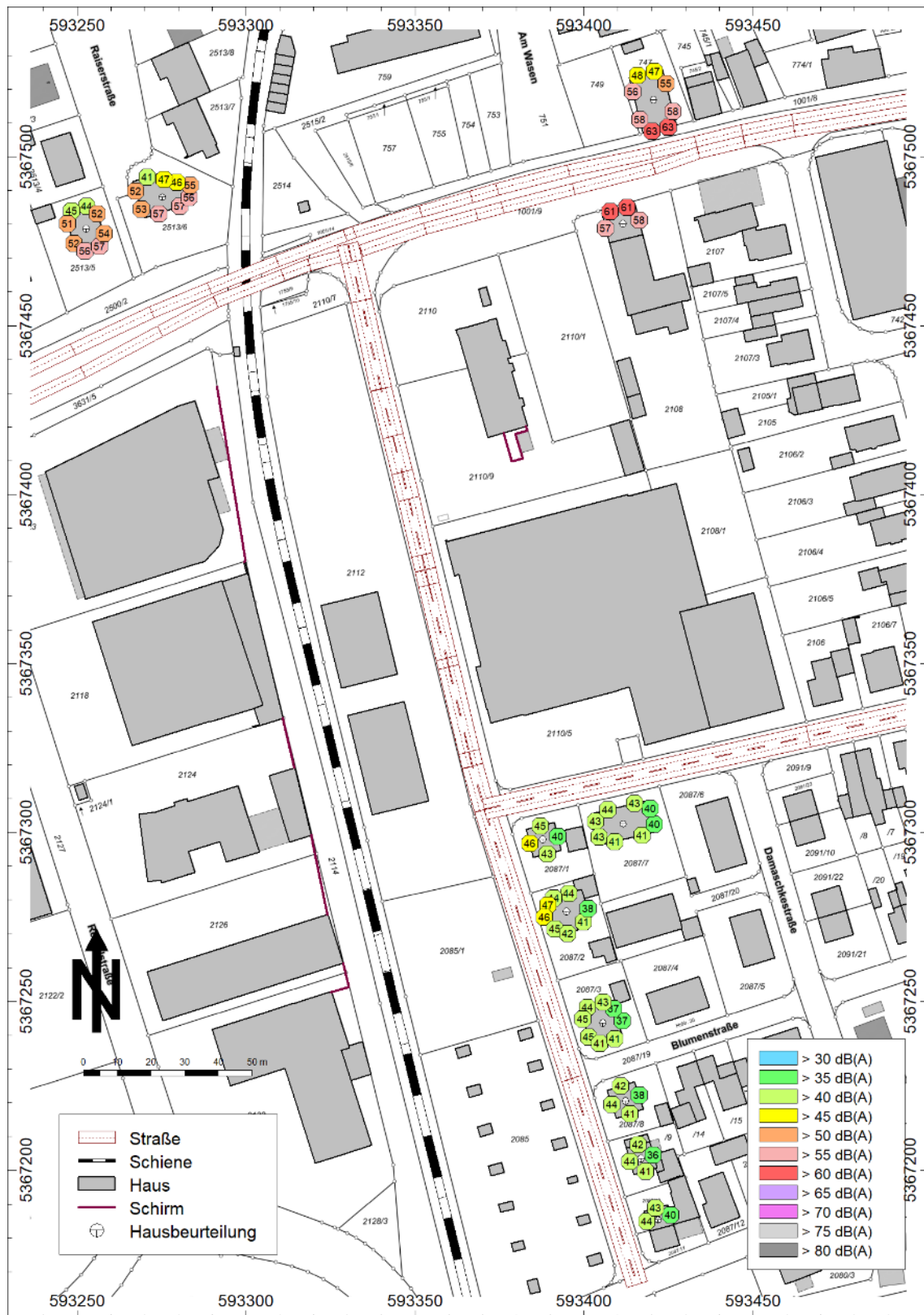
Abbildung 22: Höchster Beurteilungspegel L_r in der Nacht aufgrund von Verkehrslärm entlang der Fassaden von Wohngebäuden außerhalb des Plangebiets im Prognose Nullfall
