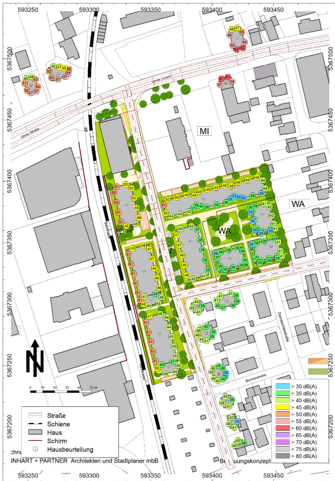
Abbildung 30: Höchster Beurteilungspegel L_p in der Nacht aufgrund von Verkehrslärm entlang der Fassaden von Wohngebäuden inner- und außerhalb des Plangebiets im Prognose Planfall mit Haus 3/4
