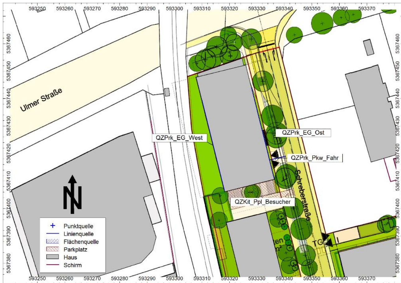
Abbildung 13: Lageplan mit Darstellung der Schallquellen der gewerblichen Nutzung im Plangebiet
