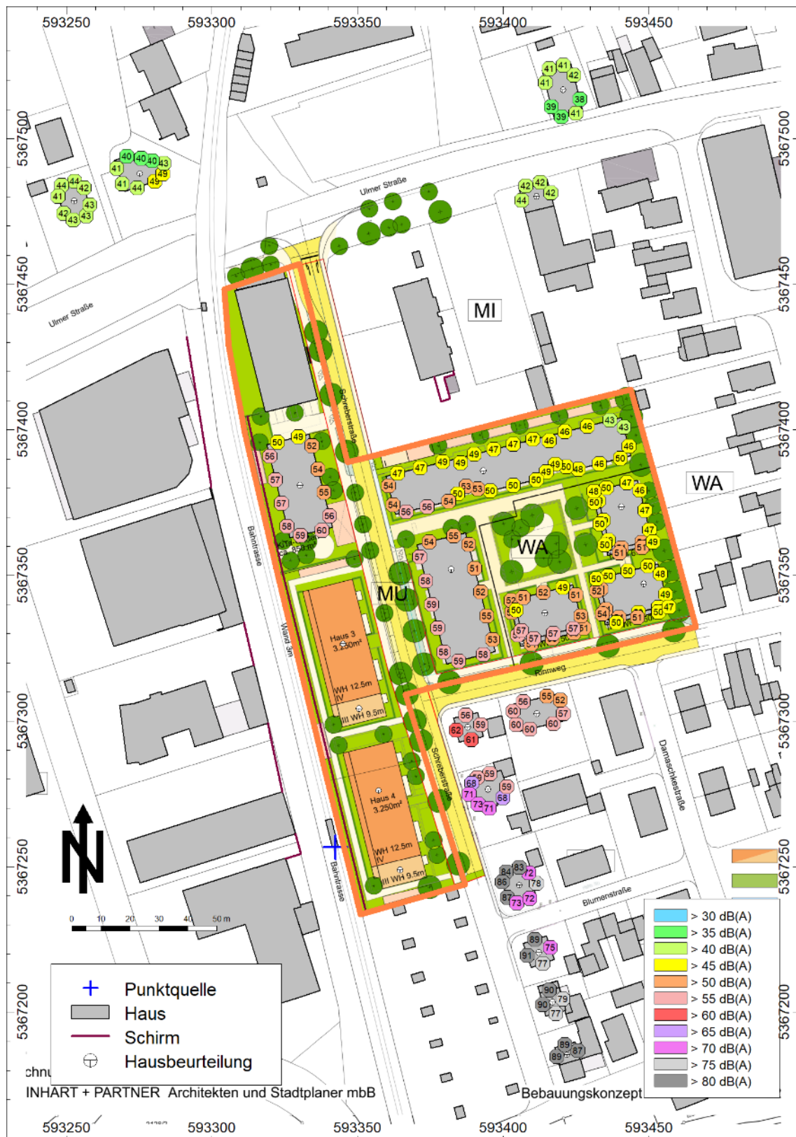
Abbildung 32: Pfeifsignale der Bahn, ausgelöst 10 m vor der Pfeiftafel, Maximalpegel L_{A,max} entlang der Fassaden von Wohngebäuden inner- und außerhalb des Plangebiets im Prognose Planfall ohne Haus 3 und Haus 4. Höchster Pegel über alle Geschosse je Fassadenabschnitt
