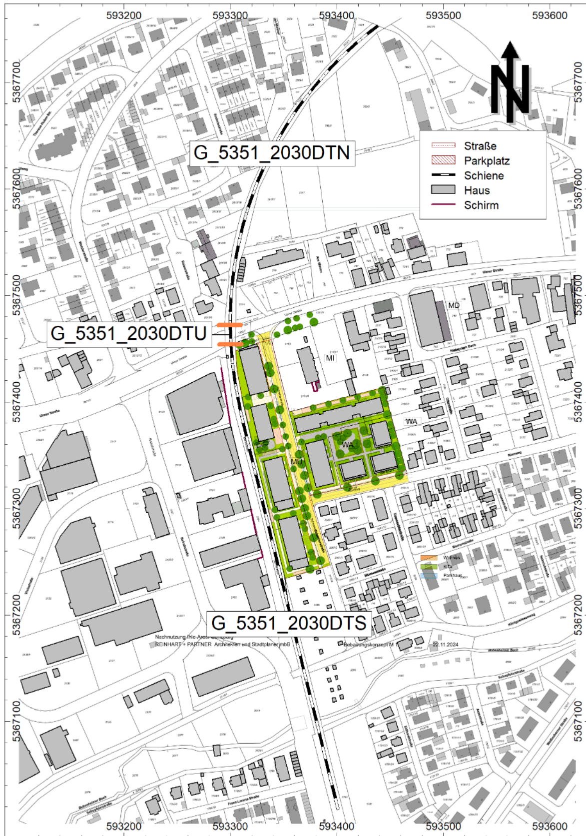
Abbildung 36: Lageplan mit Darstellung des berücksichtigten Gleisverlaufs sowie Teilabschnitte bzgl. der Verkehrslärberechnung
