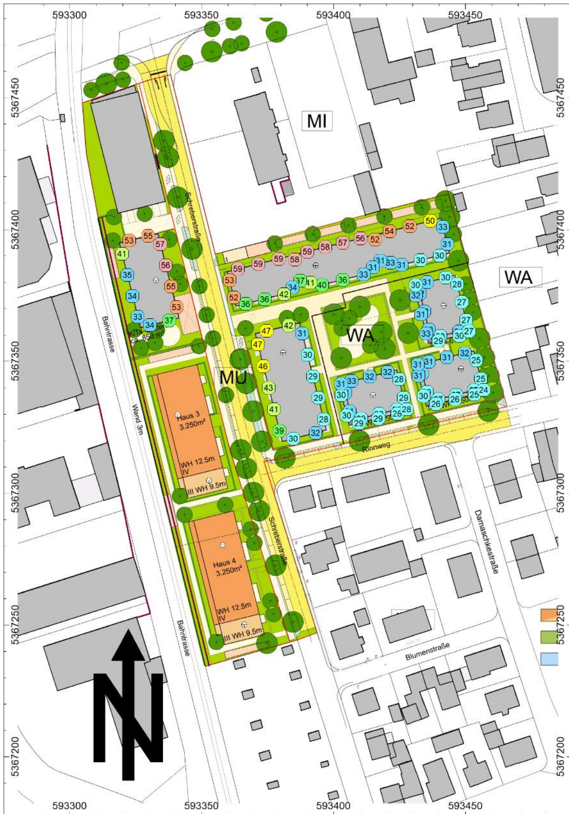
Abbildung 17: Lageplan mit Darstellung der höchsten Beurteilungspegel über alle Geschosse entlang der Fassaden der im Plangebiet vorgesehen Bebauung in der Nacht ohne Haus 3/4
