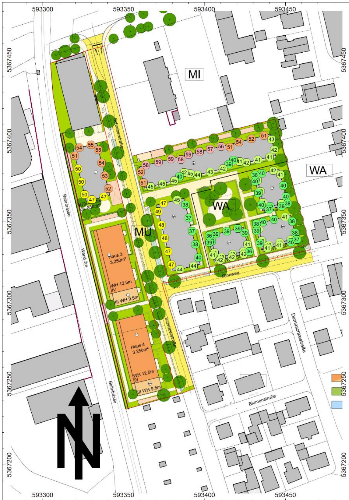
Abbildung 16: Lageplan mit Darstellung der höchsten Beurteilungspegel über alle Geschosse entlang der Fassaden der im Plangebiet vorgesehen Bebauung am Tag ohne Haus 3/4
