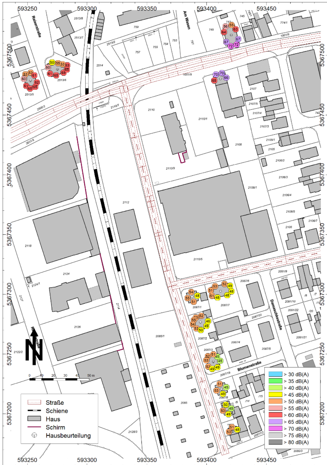
Abbildung 21: Höchster Beurteilungspegel L_r am Tag aufgrund von Verkehrslärm entlang der Fassaden von Wohngebäuden außerhalb des Plangebiets im Prognose Nullfall
