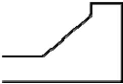
einseitiger Wendehammer für Fahrzeuge bis 10 m Länge (dreiachsiges Müllfahrzeug), ca. 20,00 m × 15,00 m
