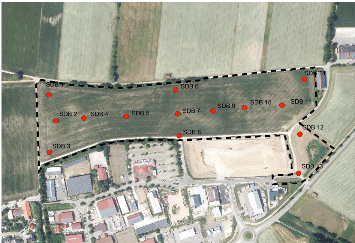
Abbildung 4: Standorte Bohrungen 1 – 14 (Luftbild Bay. Vermessungsverwaltung 2024)
