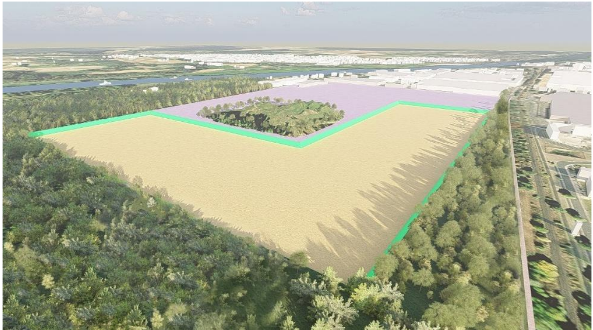
Abbildung 7: Schematische Darstellung des Geländes nach Verfüllung des Glanzstoffsees durch Verschiebung lokal vorhandener Sand- und Kiesvorkommen
