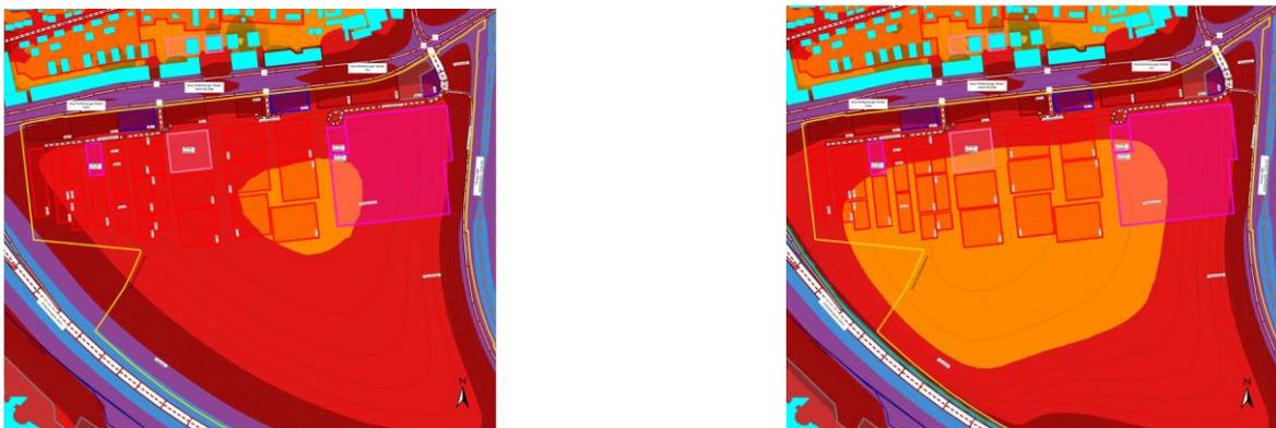
Abbildung 27 Links: Ohne Schallschutzwand entlang SWT (Lageplanskizze 7.3 des Gutachtens), rechts: Mit Schallschutzwand an SWT (Lageplanskizze 7.1) (Obermeyer, 05.06.2025); Kartengrundlage: Geobasisdaten © Bayerische Vermessungsverwaltung
