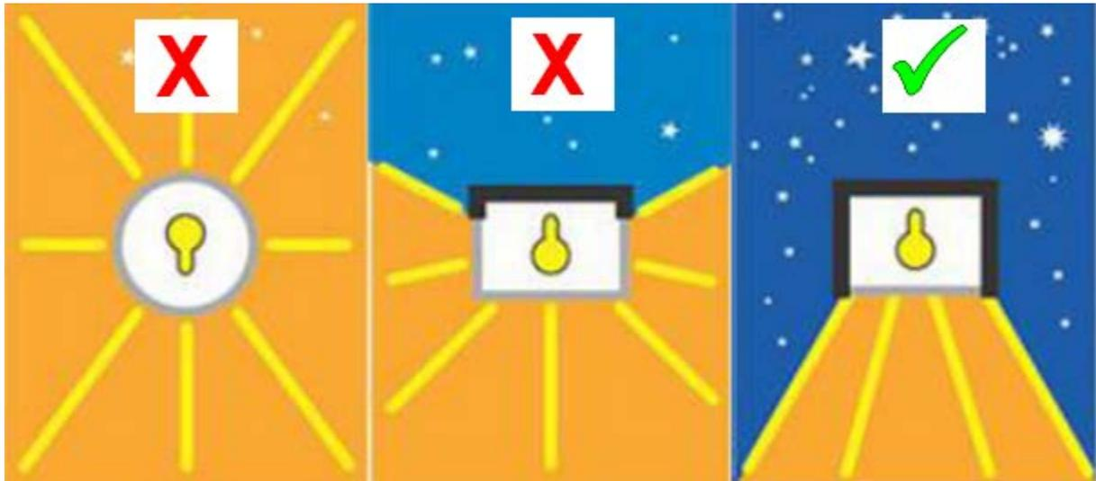
Abb. 30: Schematische Darstellung der Ausleuchtung in Abhängigkeit von der verwendeten Abschirmung des Leuchtmittels.
