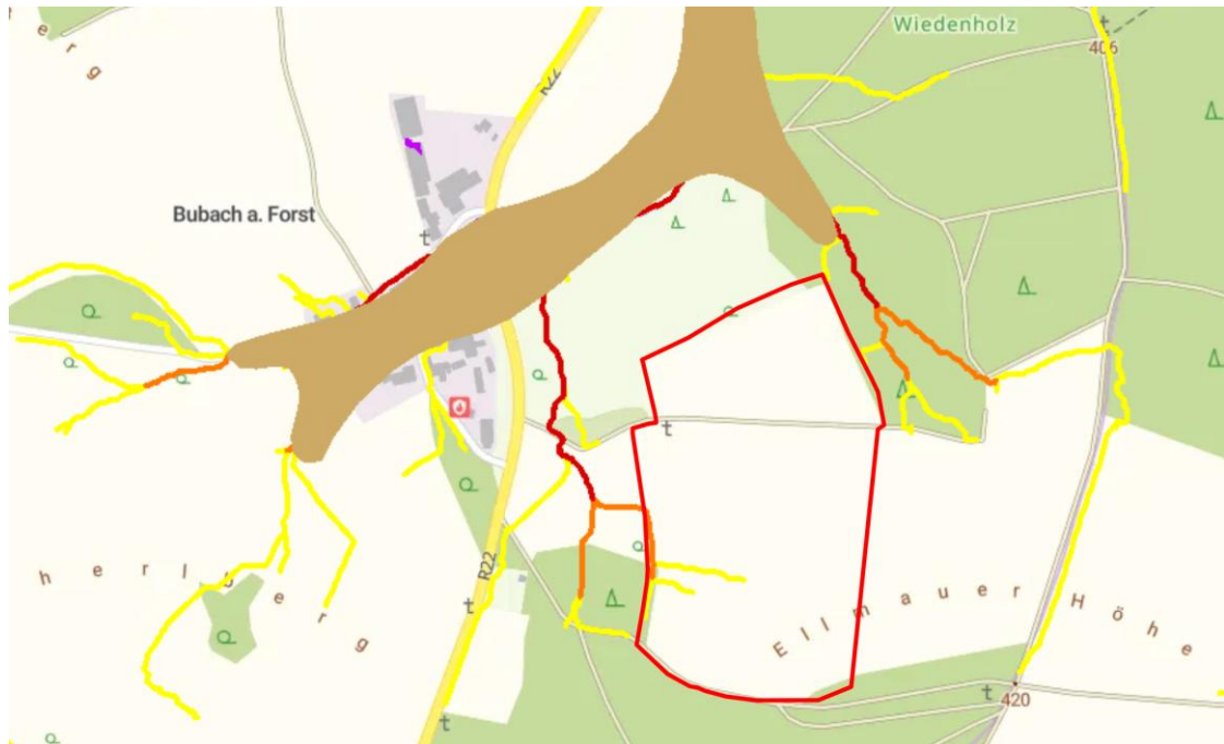
Planausschnitt, Lage des Plangebietes (schwarze Umgrenzung) sowie wassersensible Bereiche (braune Färbung) und Abflusswege mäßigem (gelbe Linie), erhöhtem (orange Linie) und starkem Abfluss (dunkelrote Linie) mit aus Geobasisdaten © Umweltatlas Bayern 20.02.2025
