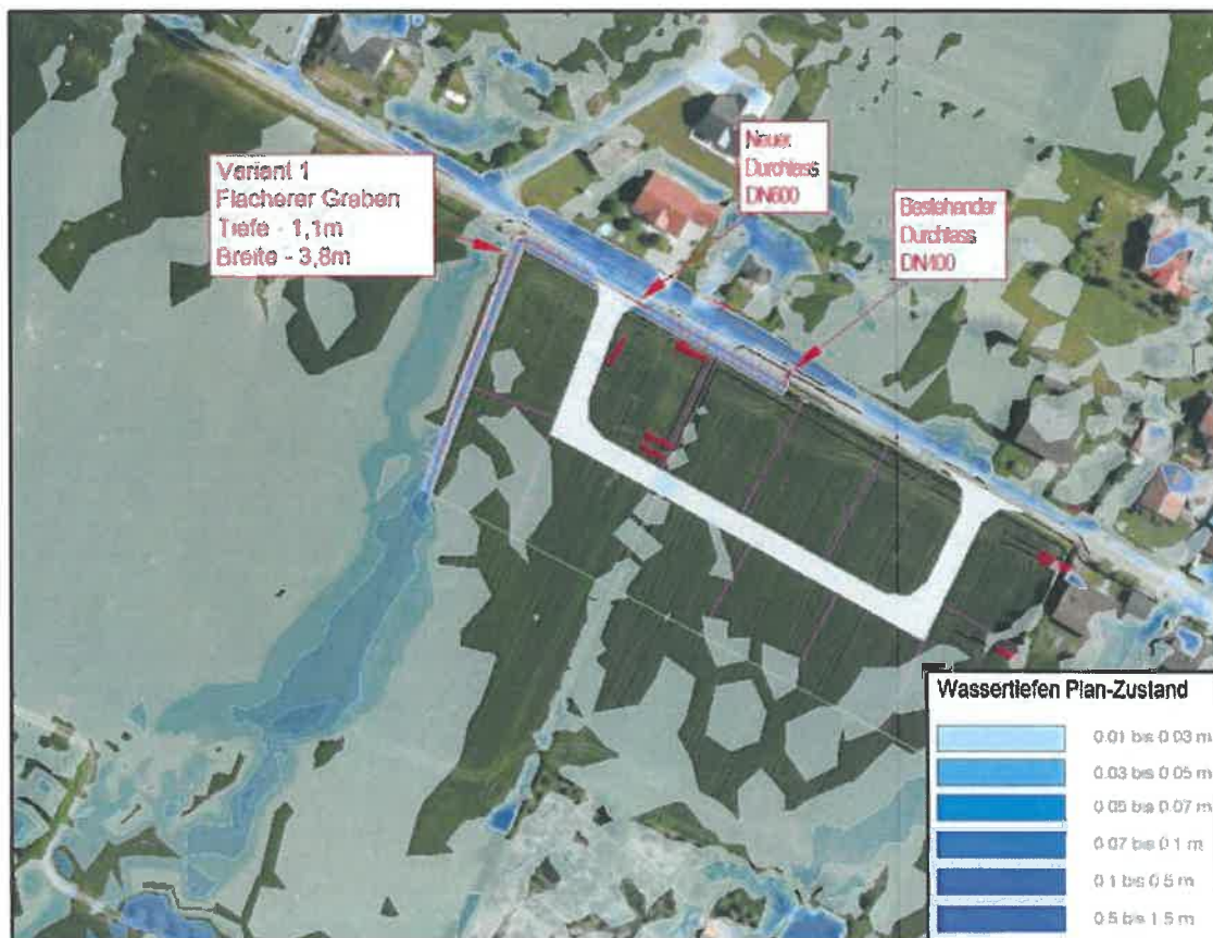
Abbildung 5. Plan-Zustand Wassertiefen mit Überlagerung des geplanten Baugebiets.
