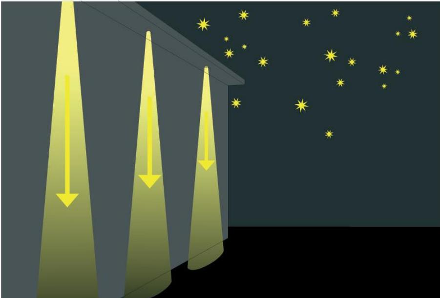
Abb. 13 Gebündelte Beleuchtung von oben auf die effektiv zu erhellende Fläche
