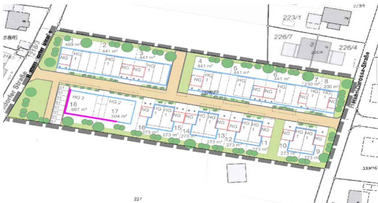
Abb. 1.4: Bebauungsplan „WA Rottersdorfer Straße II mit Darstellung der markierten und zu schützenden Fassadenbereiche.
