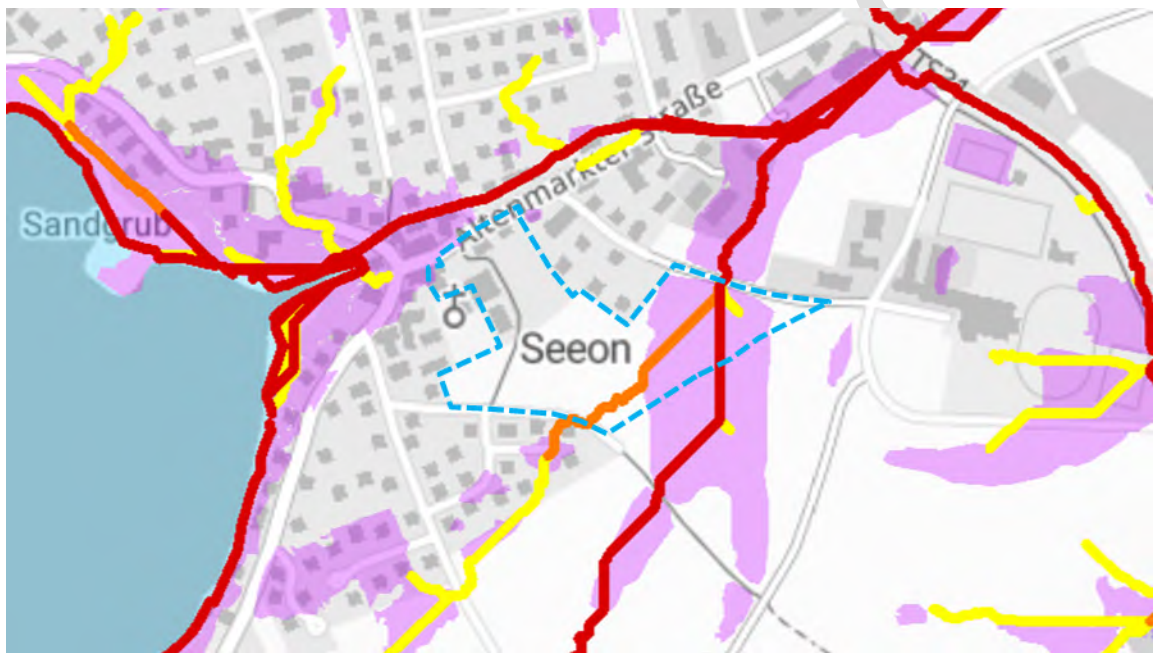
Abbildung U5: Potenzielle Fließwege und Aufstaubereiche bei Starkregen, Quelle: BayernAtlas, Abfrage September 2025: „mäßiger Abfluss“ (gelb), „erhöhter Abfluss“ (orange) und „starker Abfluss“ (rot) sowie Karteninhalt „Geländesenken und potenzielle Aufstaubereiche“ (violett) – (Geltungsbereich blau) – ohne Maßstab
