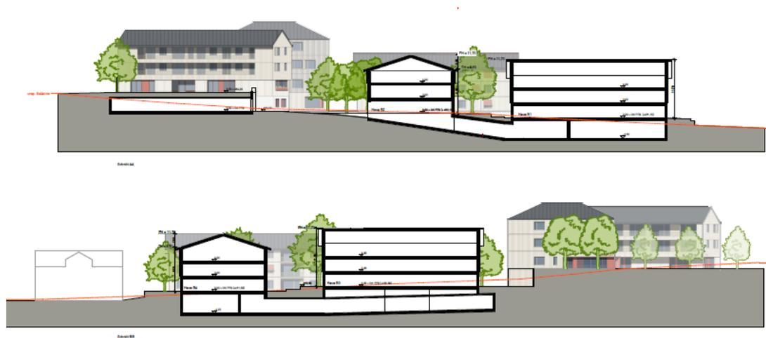
Abb. 24 Schemaschnitt durch Gelände; höherliegender Bereich: Teilbereich A, tieferliegender Bereich: Teilbereich B; Quelle: HKS Architekten, 10/2024
