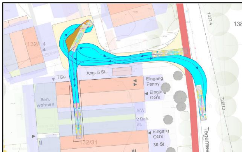
Abb. 21 Verkehrsgutachten: Schleppkurvennachweis; Quelle: IB Obermeyer
